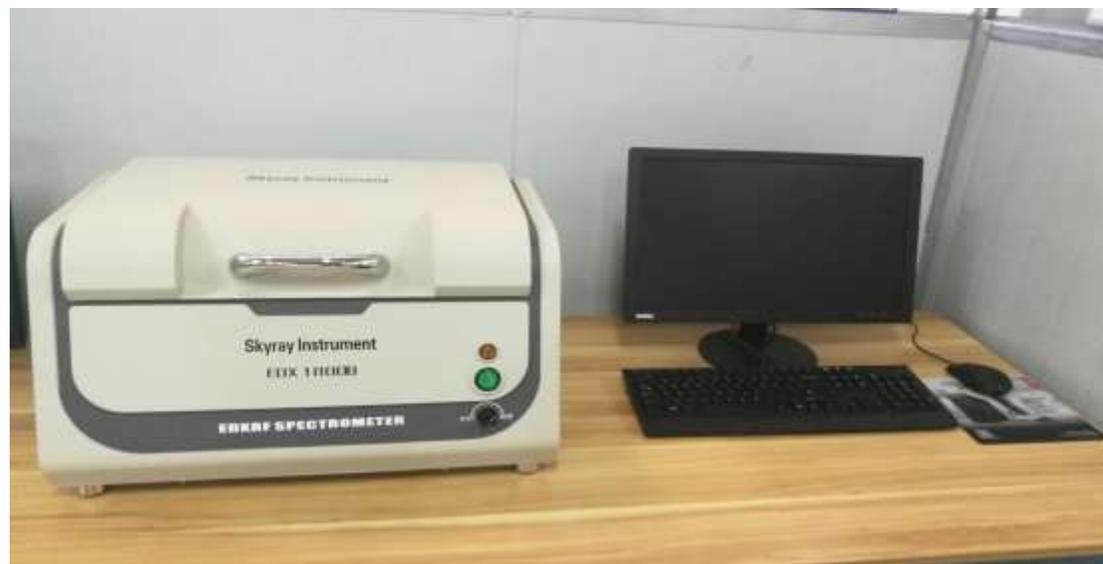
EDX 1800B可检测物涂料，金属制品，塑料制品，陶瓷材料，玻璃制品，电池等
